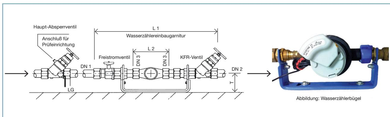
Laut den Technischen Anschlussbedingungen (TAB) der Mainova AG, Punkt 5.2.1, steht die Wasserzähleranlage, mit Ausnahme des Wasserzählers, im Eigentum unserer Kunden. Der Zählerbügel ist ein Bestandteil der Wasserzähleranlage.
