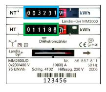
Das nebenstehende Beispiel stellt den aktuellen Zählerstand von 11188,7 **kWh** im HT und 3231,9 **kWh** im NT dar.
