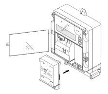
Die **Zählernummer** des Leistungszählers, die im Zusammenhang mit der Selbstablesung von Bedeutung ist finden Sie an der im rechten Schaubild dargestellten Position.
